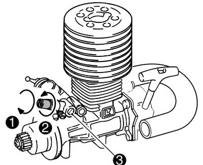
**スロー絞り調整スクリューの基本位置 / Idle Mixture Screw Position / Die Leerlauf Gemisch-Schraube / Posici n del Tornillo de Baja / Vis de reprise**
