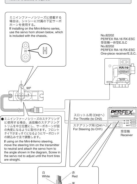
●シャシーに搭載するマウントパーツはシャシーに付属の"サーボマウントH"を使用する。 To install on the chassis, use the "Servo Mount H" included with the chassis,
