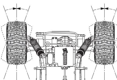
►ステアリングホイールに指を触れない(ニュートラル)ときタイヤがまっすぐになるようにステアリングトリムで微調整します。
