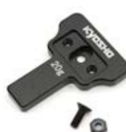
フロントシャシーウェイト (20g/MP10/MP9e EVO.) Front Chassis Weight (20g/MP10/MP9e EVO.) No.IFW604-20 *2200
