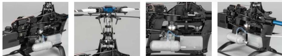
サーボヘッドをスライドさせる独創メカで、MMS(メカニカルミキシング)ながら両引きリネージュを実現。ヨーク、センターハブ、シーソーに金属パーツを採用した新開発ヘッドを採用。3D演技にも余裕で対応。キャリバーならではのベルト一次減速方式と樹脂製メインフレームで、静かなのにパワフルなフライト。組み立てやすさと3Dフライトへの対応を両立した高剛性・高強度樹脂製モノコックフレームを新開発。
