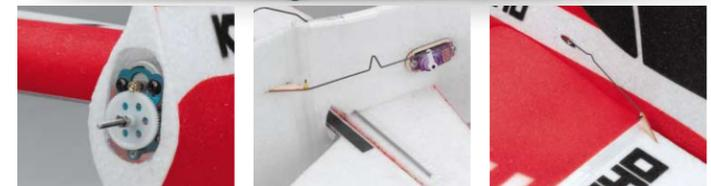
エルロンサーボを胴体内に装着し、側板ごとエルロンホーンとリンクさせる合理的構造。リンケージの調整も簡単。必要舵角も確実に確保。
