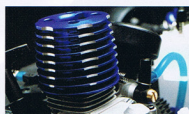
エンジン:排気量約2.44ccの空冷エンジン。燃料は高品質を 使う。キャブレターのニードルを調整してセッティングを行う。
