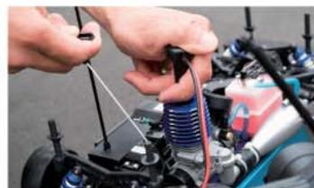
緊張のエンジンスタート。プラグヒーターでプラグを加熱、スターターを数回引けばエンジンはかかる。コツは手のスナップだ。
