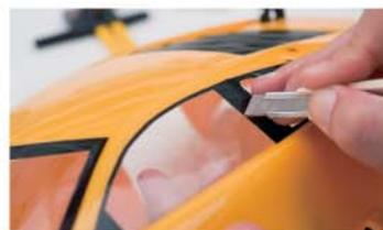
ボディを加工し、エンジンの冷却のための穴やメンテナンス用の穴を開ける。サイドウィンドーは通常のカッターで開ける。
