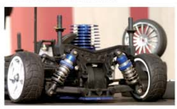
ボディカウルを外した状態での後ろ姿。交換したセミスリックタイヤは実車同様に溝の向きで回転方向がある。
