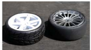
左が今回、交換したセミスリックタイヤ。溝付きだが、ソフトコンパウンド仕様なのでグリップはかなり高い。
