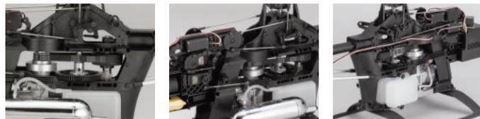
ベルト一次減速方式と樹脂製メインフレームで、静かなのにパワフルなフライト。アルミダイキャストクラッチドラム採用。サーボベッドをスライドさせる独創メカで、MMS(メカニカルミキシング)ながら両引きリンク機構を実現。エルロン、エレベーター、ピッチコンを完全両引きリンク機構として逃げのない確実な操縦性を獲得。アルミクラッチドラム&ブリー、ハーフ金属スワッシュプレート、ヘッド等には3D演技対応の金属パーツを採用。組み立てやすさと3Dフライトへの対応を両立した高剛性・高強度樹脂製モノコックフレームを新開発。完成まで短時間。受信機&バッテリー用メカボックスで配線スッキリ。フルベアリング仕様。シャープなボディとローライト軽量プレースの新新スタイリング。80ccサブタンク標準装備。
