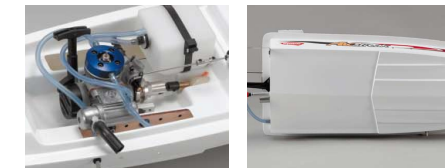
新設計GXR15MRエンジン FRP船体V字型ステップ平面形
