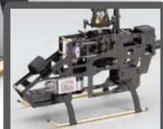
高剛性で軽量の1mm厚カーボン製ボックス構造メインフレームを新開発。ギヤ軸を集約し、駆動ロスの軽減と軸間距離調整が容易に。
