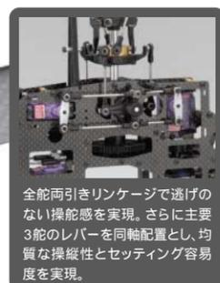
全舵両引きリンクageで逃げのない操舵感を実現。さらに主要3舵のレバーを同軸配置とし、均質な操縦性とセッティング容易度を実現。
