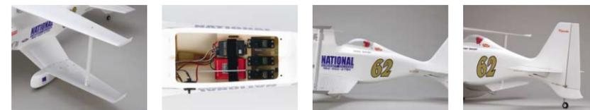
バルサ製で軽量仕上げの逆ガルウイングに、FRP製のホイールパンツを一体化。複雑なフォルムながら、軽量化を実現。FRP胴体が複雑なディテールと、ゆとりメカニズムを軽量化を犠牲にすることなく実現。幅広い胴体側面積、逆ガルウイングの下翼等々、実機を忠実に再現。短く短いウイングと逆ガルウイングは、伸びのある飛行を披露。模型化に際し、スムーズな離陸を促す静止迎角を得るべく尾輪高を適正化。ショック吸収性も発揮して、タッチダウン時にも安心。
