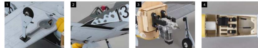
引込み脚と加工済みリンクを装着済み、脚の格納に連動してタイヤカバーも閉閉。 スプリットフラップを標準装備。離着陸時はもちろん、フライトの幅を広げる活用が可能。 4サイクル50クラスエンジン他、様々なエンジンを多彩なスタイルで搭載可能なマウント付。 剛性に優れたFRP製ロッドを採用し、大きなGにもたわみが少なく正確な操舵感を実現。その他リンクに必要パーツを付属した充実のキット内容。
