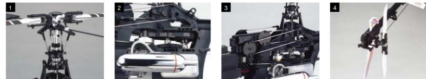
ヨーク、センターハブ、シーソーに金属パーツを採用し、瞬発力の必要な3D演技にも余裕に対応。 キャリアーならではのベルト駆動2段減速ミッションで駆動ノイズを抑えながら高効率にパワー伝達。 EMS操舵機構と全舵両引きリンク(スロットルを除く)により、ダイレクト感あふれる操縦性を実現。 クラスで唯一ラダーも両引きリンクとした、確実に逃げないテールコントロールを実現。
