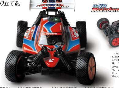
1/8インファーノMP777のフォルムを 1/16サイズで再現。 すべて完成している レディセット。 ベアリング12個を標準装 備。 ブレーキ&バック付スピードコント ロールアンプ内蔵。 最長35分の長時間走 行。 スリッパーギヤを装備した4WDシャ シー。 多彩なセッティングポイントと付属 パーツ。 豊富なオプションパーツを用意。
